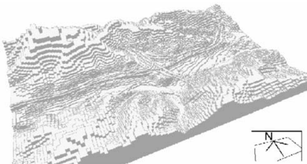
図3 圏央道八王子JCTのソリッドモデル
