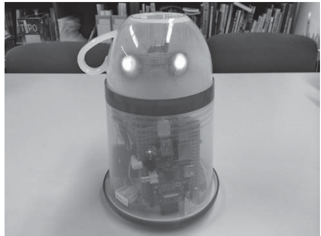
写真5 2013年のマグボット タイヤをなくして Raspberry Pi を内蔵
