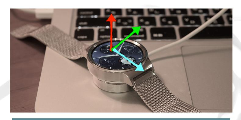
加速度センサは端末の動きを検出するセンサです。 縦横高さ(XYZ)3方向の加速度を検出します。
