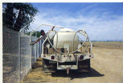
散水車による灌漑。故障などで灌漑ができない場所には、応急処置的に散水車でスポット灌漑する。
